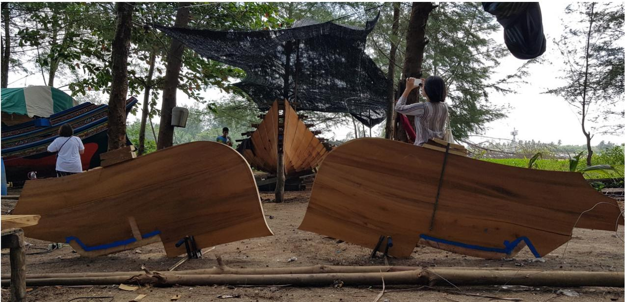
陶公府仍有多處維持著小型漁村群聚的生活型態。圖為他們的傳統捕魚船戈列（Korlae）。仍遵循傳統造法，一艘漁船使用單一棵香坡壘樹，並必須由漁船訂製者砍伐交由造船師製造。製作需耗時約半年至一年。
